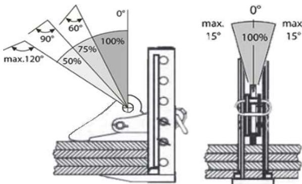
Tragfähigkeit bei Schrägstellung
